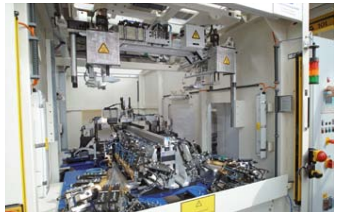
Inline-Anlage mit Shuttle-System
